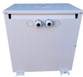
Die Transformatorengehäuse sind für die vertikale Montage verschiedener Typen von Einphase-, Dreiphasen- und medizinischen Transformatoren bestimmt. Wir bieten Gehäuse für Drosseln und Transformatoren an, die der IP23-Schutzart entsprechen. Sie sind aus pulverbeschichtetem Stahlblech in RAL 7035 gefertigt. Die Klemmen sind durch Abnehmen der oberen Abdeckung zugänglich.
