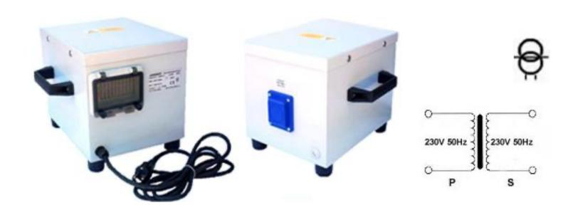
Sie werden dort eingesetzt, wo die Verwendung von vom Netz getrennten Stromkreisen erforderlich ist. Sie werden hauptsächlich in feuchten Tankumgebungen, aber auch unter anderen schwierigen Bedingungen eingesetzt. Da sie kompakt und leicht zu transportieren sind, lassen sie sich je nach Bedarf leicht an verschiedenen Orten einsetzen.
